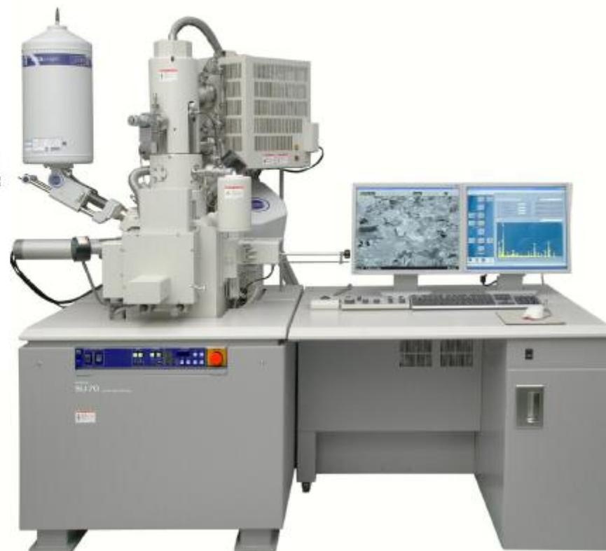
*Наилучшее разрешение может быть получено при использовании вторичных электронов при работе в высоком вакууме.*
