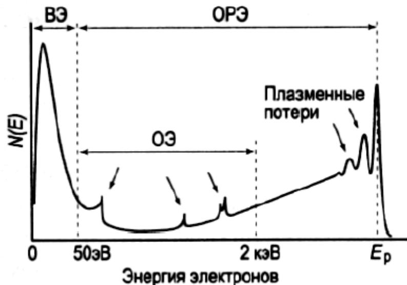
**Вторичные электроны (ВЭ)** выходят из тонкого слоя (5-20 нм) и дают информацию о топографии поверхности.
