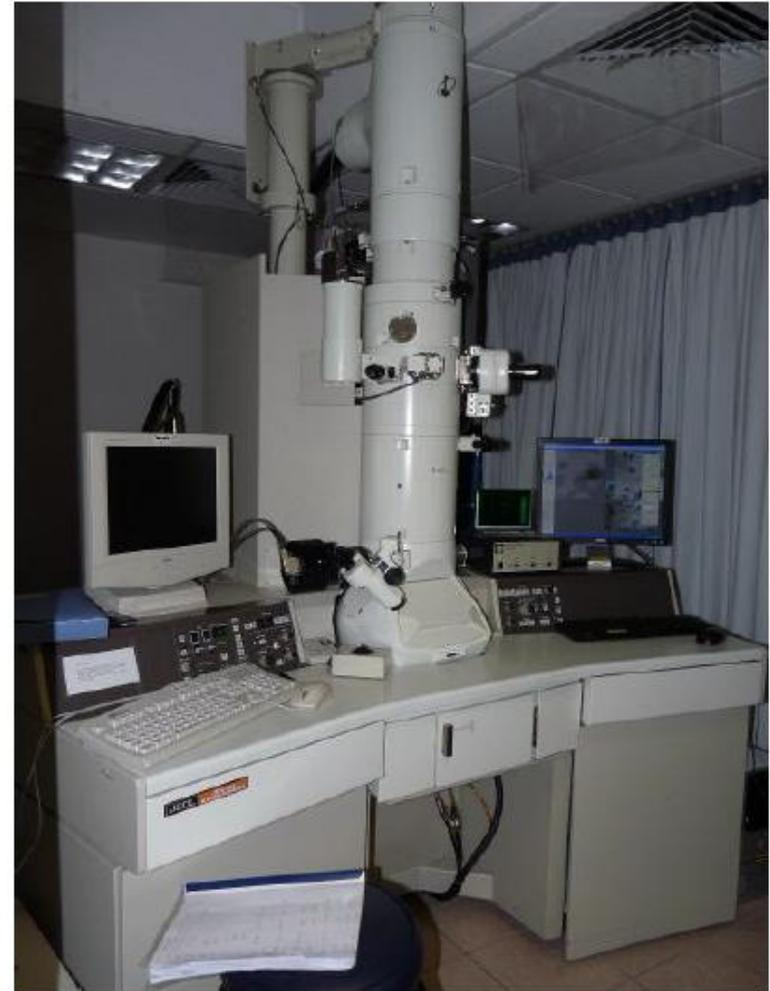
*Электроны эмитируются в электронном микроскопе посредством термоэлектронной эмиссии из нити накаливания (например, вольфрамовая проволока) либо посредством полевой эмиссии. Затем электроны ускоряются высокой разностью потенциалов (от 100 кВ до 3 МВ) и фокусируются на образце электромагнитными или электростатическими линзами. Прошедший через образец луч содержит информацию об электронной плотности, фазе и периодичности; которые используются при формировании изображения.*
