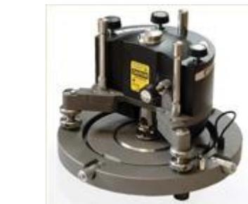
*Принцип работы атомно-силового микроскопа основан на регистрации силового взаимодействия между поверхностью исследуемого образца и зондом. В качестве зонда используется наноразмерное остриё, располагающееся на конце упругой консоли, называемой кантиливером.*
