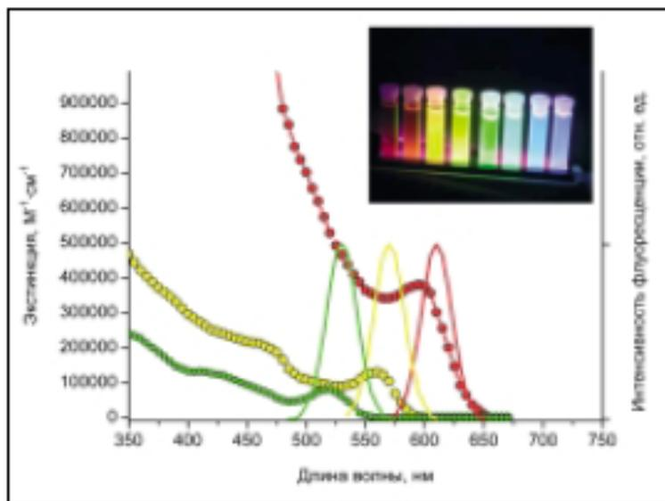
**РИСУНОК 1** | Спектры поглощения и флуоресценции сферических CdSe/ZnS нанокристаллов структуры ядро/оболочка. Диаметр CdSe ядер: 2.5 нм (зеленые), 3.3 нм (желтые) и 4.8 нм (красные). На вставке — флуоресценция CdSe/ZnS нанокристаллов разных размеров. Для всех нанокристаллов использован один источник возбуждения — ртутная лампа.
