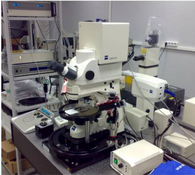
Лазерный сканирующий микроскоп Zeiss LSM-510 NLO
