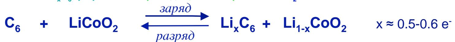
Напряжение: 3.6 в  $E^\circ(\text{cathodic}) - E^\circ(\text{anodic}) = E^\circ(\text{cell})$
