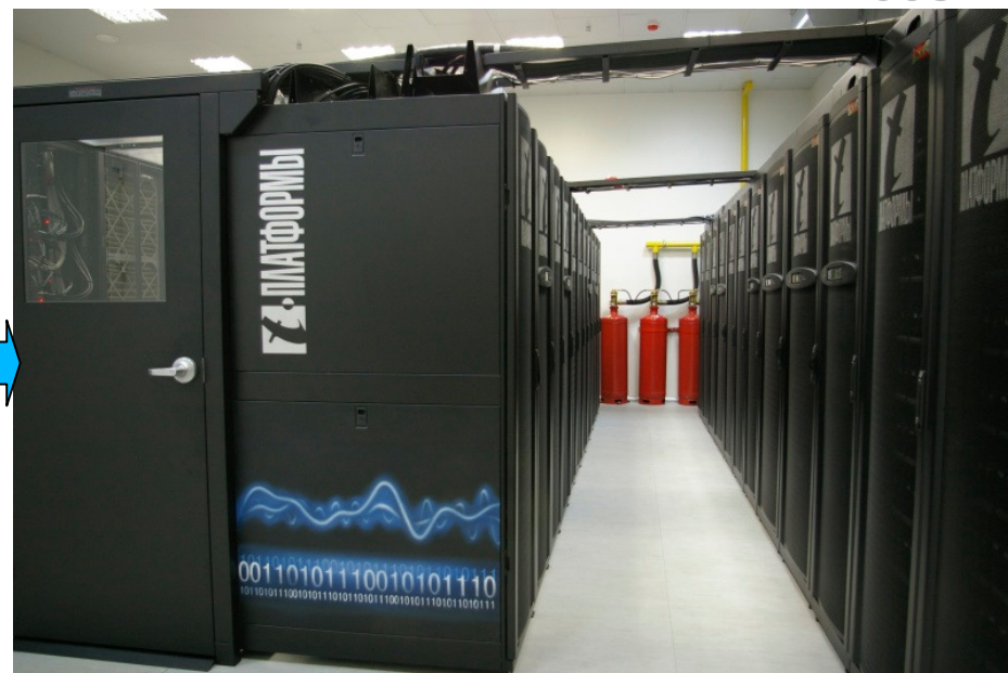
Суперкомпьютер Чебышев Выполняет до 60 Тфлоп: 6 \times 10^{13} оп/с
