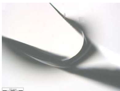
Рис. 9. Фотография мениска воды между элементарными волокнами «Torayca», выполненная на оптическом микроскопе; увеличение X200.
