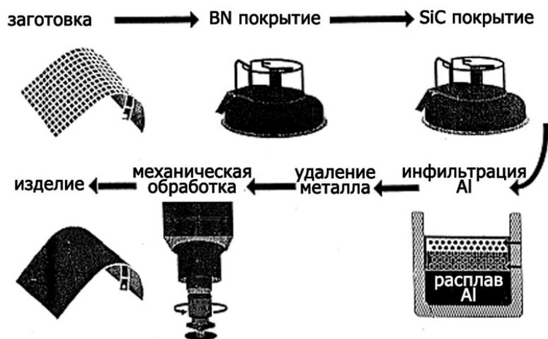
Рис. 27. Схема производства композитов с  $Al_2O_3/Al$ -матрицей методом «прямого окисления металла» [29].
