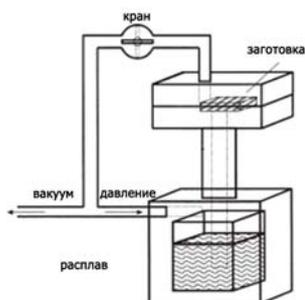
Рис. 31. Схема производства металлического композита, упрочненного керамическими волокнами методом инфильтрации под давлением [1].
