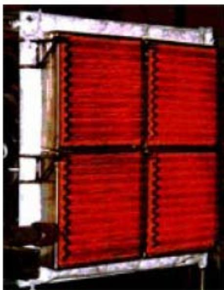
Рис. 28. Отражатель газового потока из армированного керамическими волокнами карбида кремния [29].
