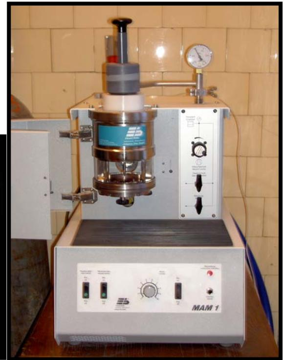
• Прибор для высокотемпературного жидкофазного синтеза – установка индукционного нагрева.
