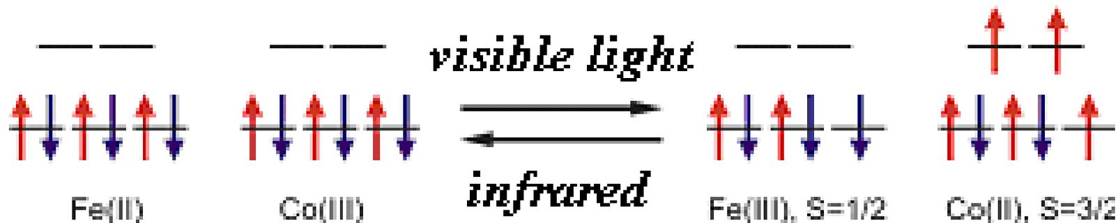
Формирование ферромагнитных структур возможно из “немагнитного” состояния под действием видимого света. За счет внутреннего фотоэффекта комбинация Fe<sup>2+</sup>, Co<sup>3+</sup> может быть переведена в комбинацию Fe<sup>3+</sup>, Co<sup>2+</sup>, что будет сопровождаться возникновением магнитного момента (фотоманетизм).
