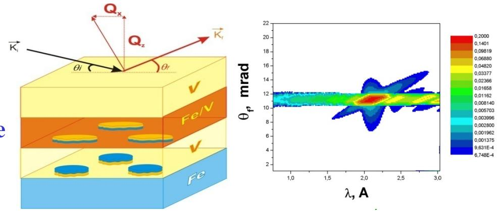
Рефлектометрический эксперимент на многослойной наноструктуре
