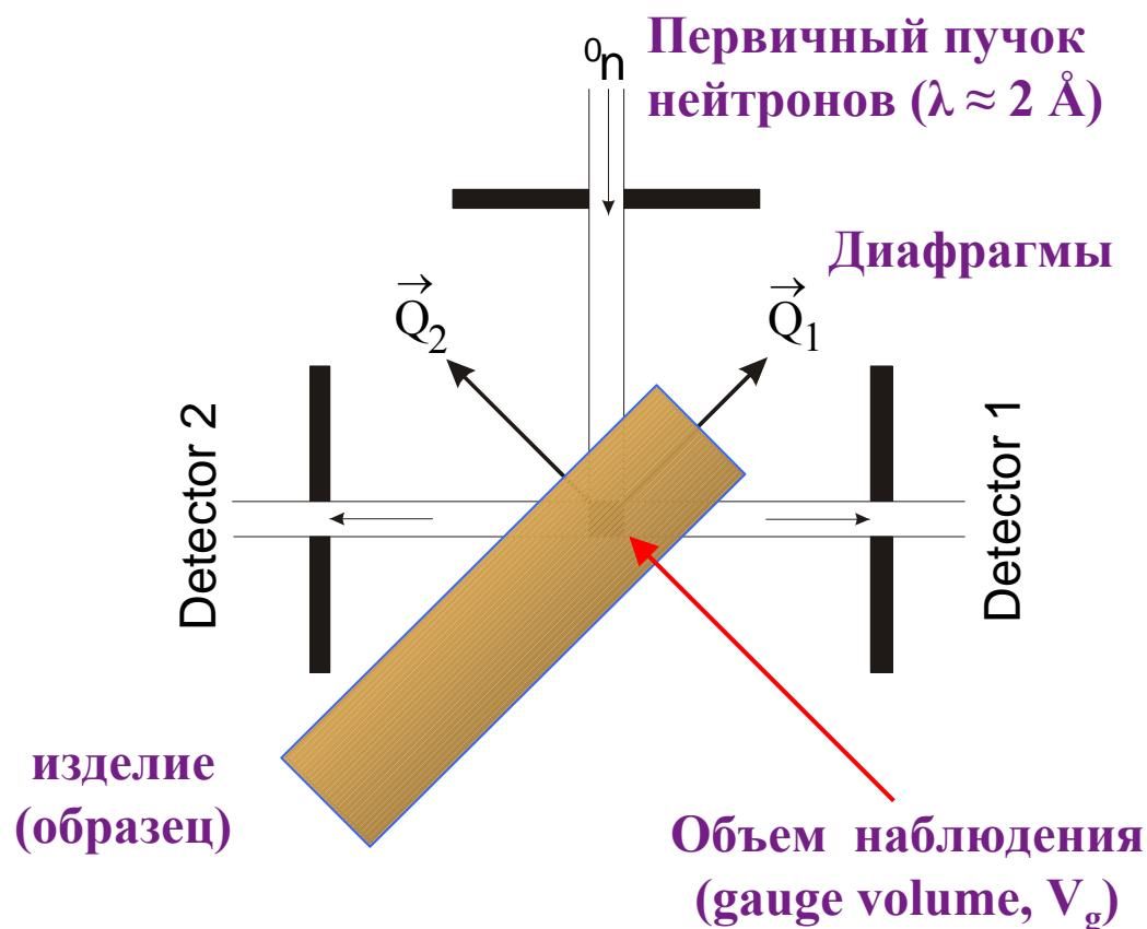
Использование  $\pm 90^\circ$ -детекторов позволяет определять деформации в двух направлениях  $Q_1$  и  $Q_2$ .
