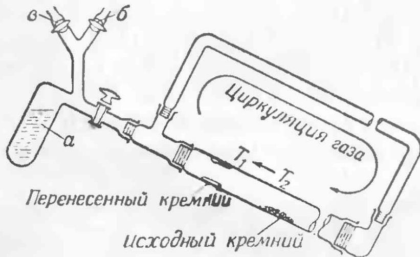
Р и с. 6. Движение газа за счет конвекции. Схема установки для транспорта кремния в атмосфере \text{SiF}_4 [18].
