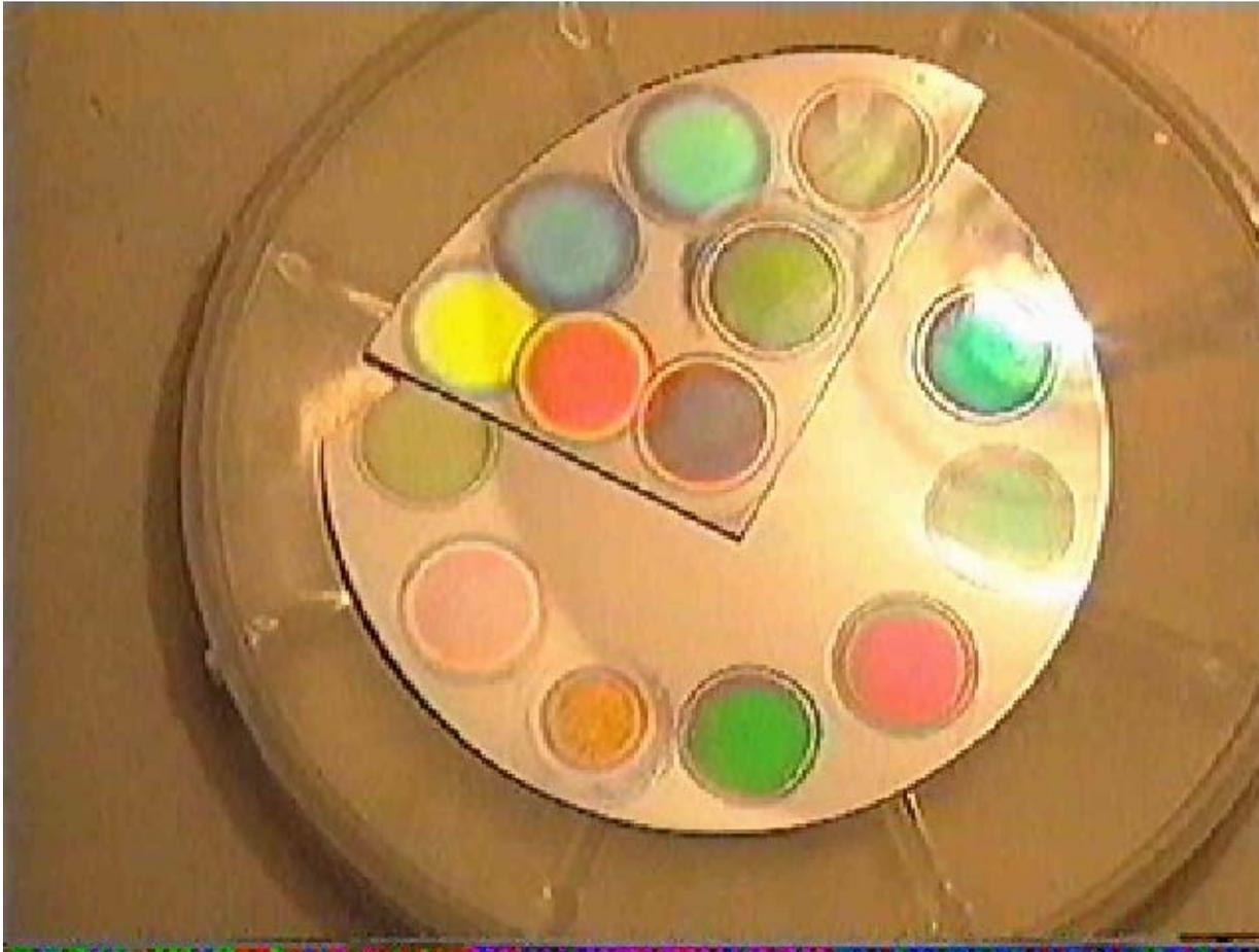
Эффективные оптические свойства слоев мезопористого кремния (цветные круглые области) определяются упорядоченной структурой пор и кремниевых нанокристаллов. В результате чего они значительно отличаются от свойств кристаллического кремния  $c\text{-Si}$ , из которого изготовлены.
