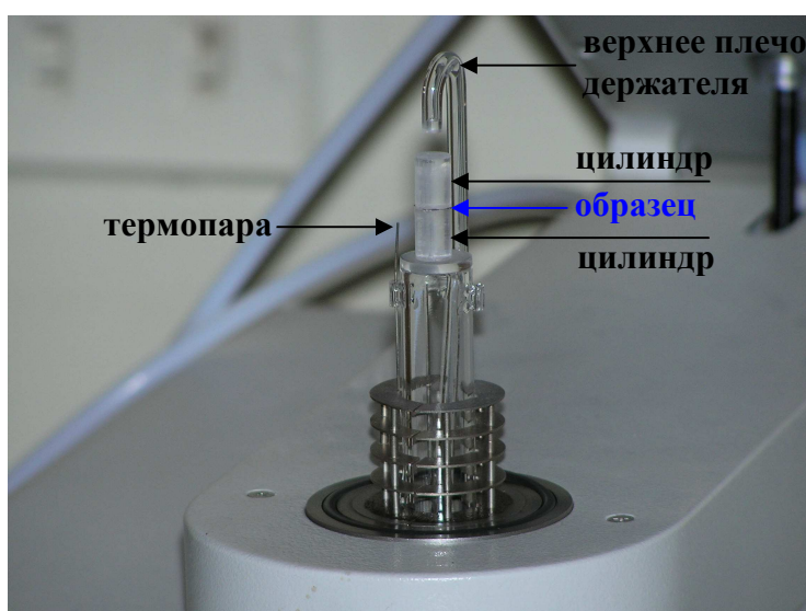
Рис. 3. Установка образца в держатель ТМА.
