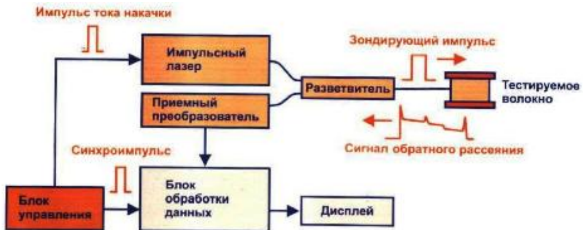
Рис. 4. Блок-схема импульсного оптического рефлектометра
