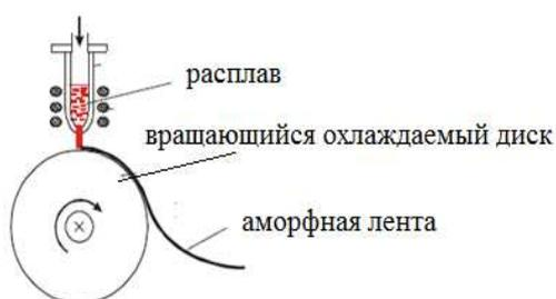
**Рис. 1.** Схема получения лент аморфных сплавов методом спиннингования расплава
