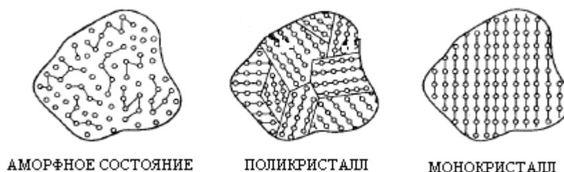
**Рис.2.** Атомная структура аморфного состояния, поликристаллического, монокристаллического
