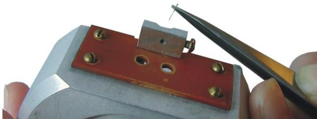
Рис. 11. Установка иглы в держатель головки СТМ
